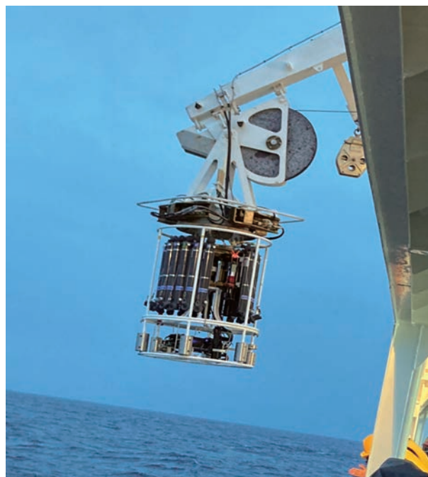
観測測器のCTD。 船から吊るされ、毎秒1mで海底（最大3000m）へ降下していく。
