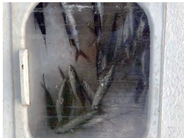
アクリル板越しに見たFSCの内部。魚と氷が良く見える。スライディング窓を透明なアクリル板にしたことが功を奏した。
